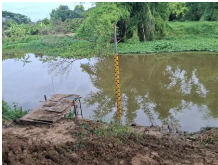
รูปที่ 2-29 การติดตั้งเสาวัดระดับในแม่น้ำกวัง
