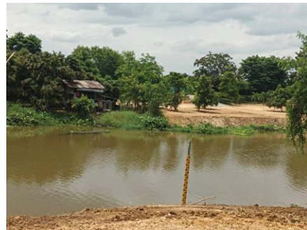
รูปที่ 2-29 การติดตั้งเสาวัดระดับในแม่น้ำกวัง
